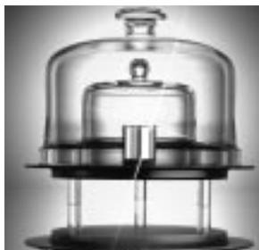
El kilogramo patrón es un cilindro de platino/iridio (90/10) de 39 mm de diámetro y 39 mm de altura con una densidad de  $21,5 \text{ g/cm}^3$ .
